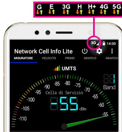
Fig.2 Esempio di misurazione segnale della rete 3G tramite App gratuita (Network Cell Info Lite)
